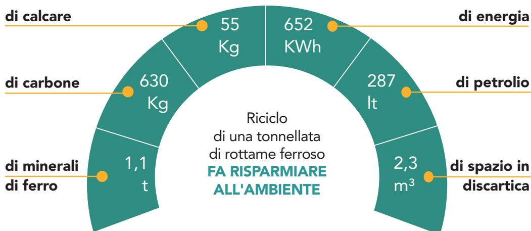
Il riciclo dell'acciaio, attraverso la rifusione del rottame ferroso, consente infatti evidenti benefici sia in termini di risparmio di risorse naturali che in termini energetici e di emissioni di CO2. Per esemplificare con un numero questo concetto, si può calcolare che per ogni tonnellata di rottame di acciaio al carbonio riciclato si ottiene un risparmio di CO2 pari a 1,4 tCO2 (metodologia LCA di World Steel).
